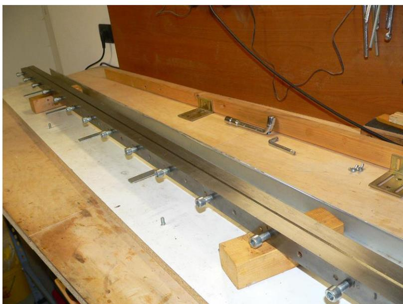
Foto 38 – supporto per pialletto senza la guida rimovibile
