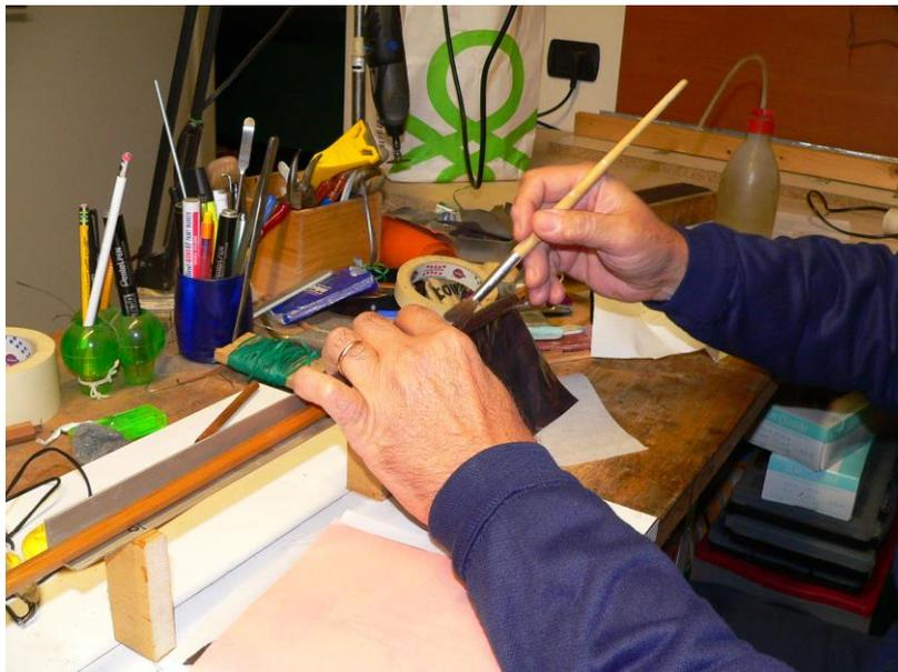
Foto 65 – si distende e si fa aderire la lamina con un pennello e si lascia asciugare
