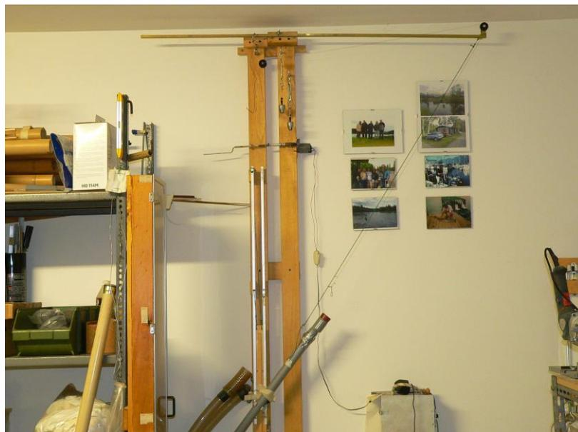
Foto 73 – sistema per estrazione della canna in diagonale (tubo per vernice e asta con carrucola per estrazione della canna, motorino elettrico, cavo guida, il cavo di trazione s'intravede agganciato al cavo guida)
