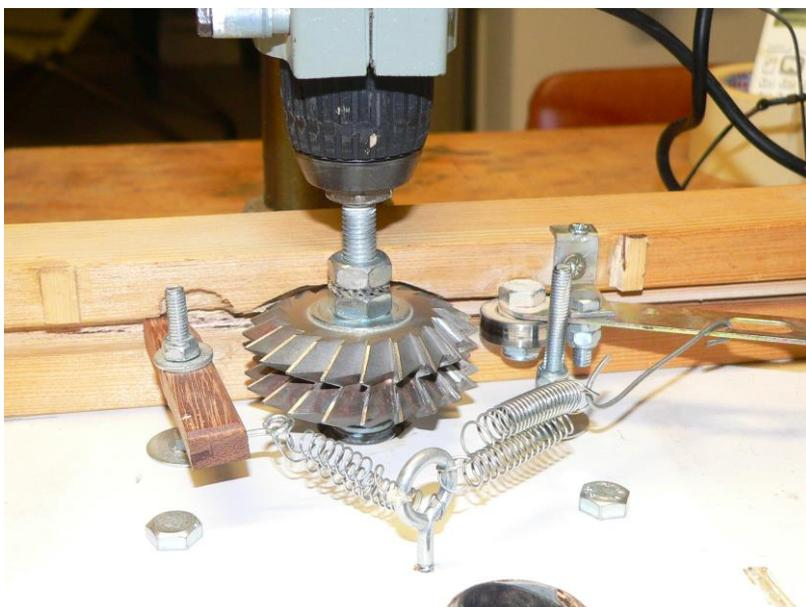
Foto 23 – particolare delle frese e delle leve di tenuta in guida
