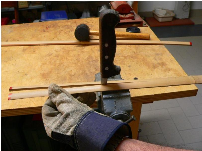
Foto 9, splittaggio con coltello tenuto in morsa (notare che il pomolo del manico è fissato in modo da proteggere la mano destra che spinge il listello)
