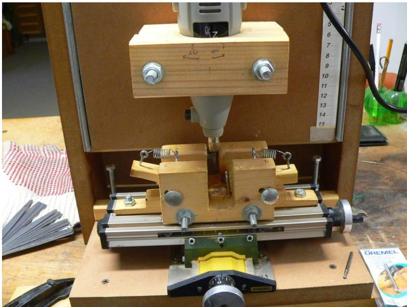
Foto 45 – viti sotto la lastra verticale per bloccaggio della discesa della fresa
