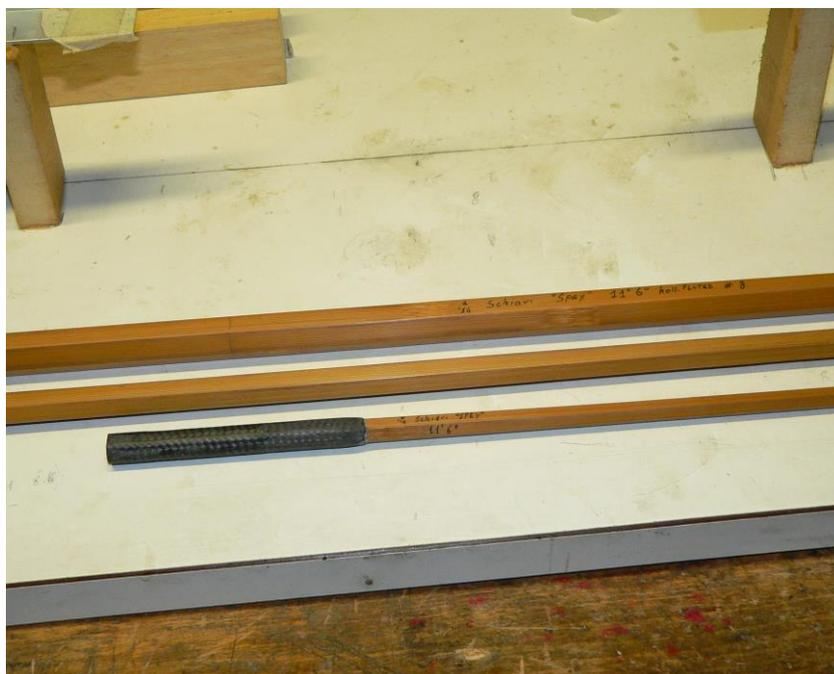
Foto 61 – risultato finale (con identificazioni, ricopertura di shellac e ferrula in grafite ancora da rivestire)
