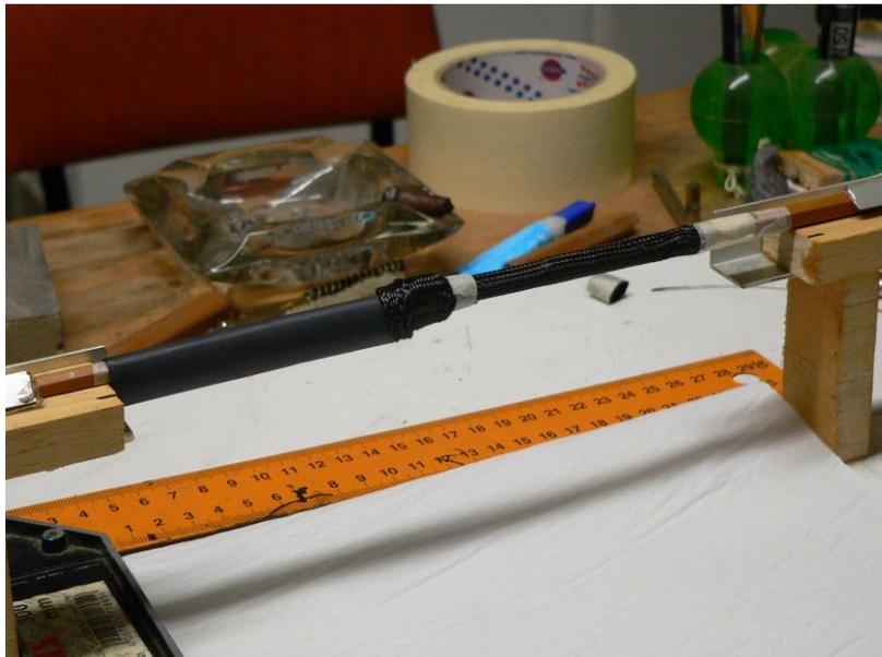
Foto 57 – posizionamento della prima calza; la seconda si vede sulla sinistra (sporgente in parte dal tubo termorestringente) pronta per essere sovrapposta alla prima dopo che è stata spalmata di resina
