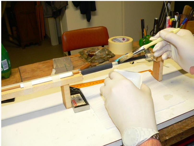
Foto 58 – spargimento della resina sulle 2 calze sovrapposte (sulla sinistra si vede il tubo termorestringente pronto per essere posizionato sulle calze)
