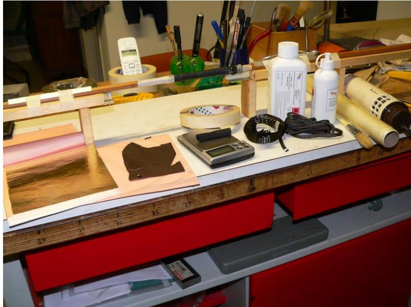
Foto 56 – materiali per costruzione di ferrule in grafite appoggiati sulla base del supporto della canna (calze in grafite, resina bicomponente, pellicola, phon, tubo termorestringente, bilancia per pesare la resina, foglia in bronzo, pennelli)
