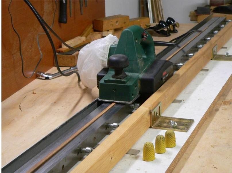
Foto 40 – pialletto pronto su supporto con entrambe le guide installate
