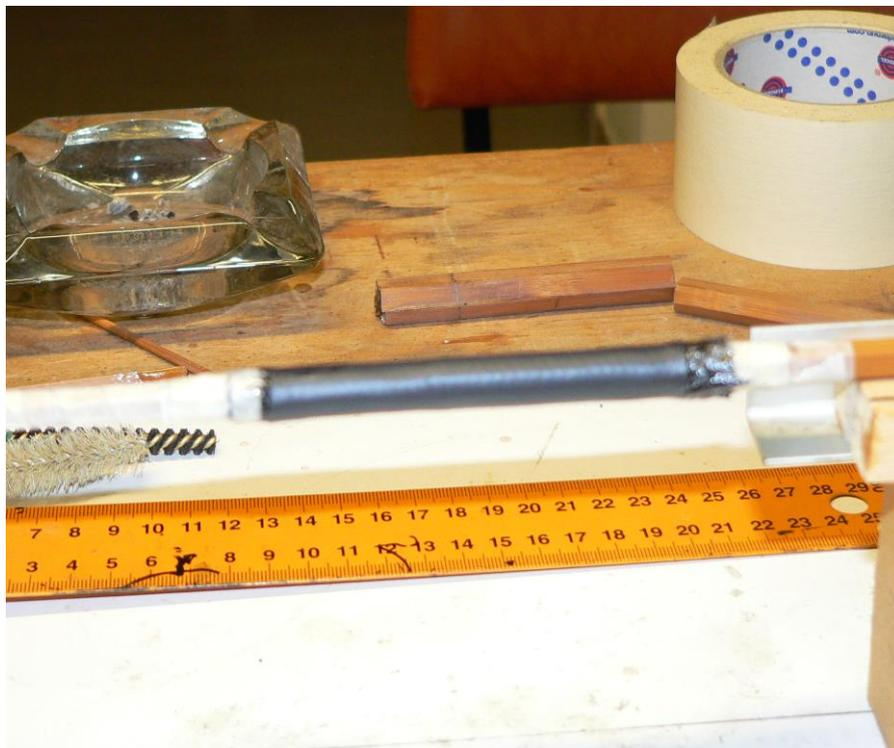
Foto 60 – ferrula terminata ed in asciugatura (dopo verranno eliminati il tubo termorestringente e, con cautela, le parti terminali in eccesso)
