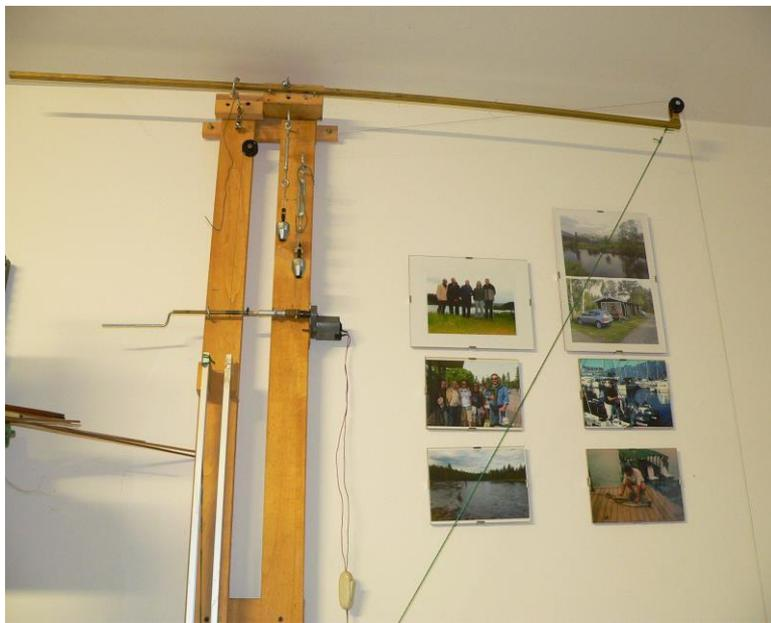
Foto 75 – particolare del motorino elettrico che trazona il cavo per l'estrazione della canna avvolgendolo su un tubo di dimensioni adeguate per avere una velocità di estrazione di ca. 10 cm al minuto (il cavo poi arriva al tubo passando per 2 piccole carrucole).
