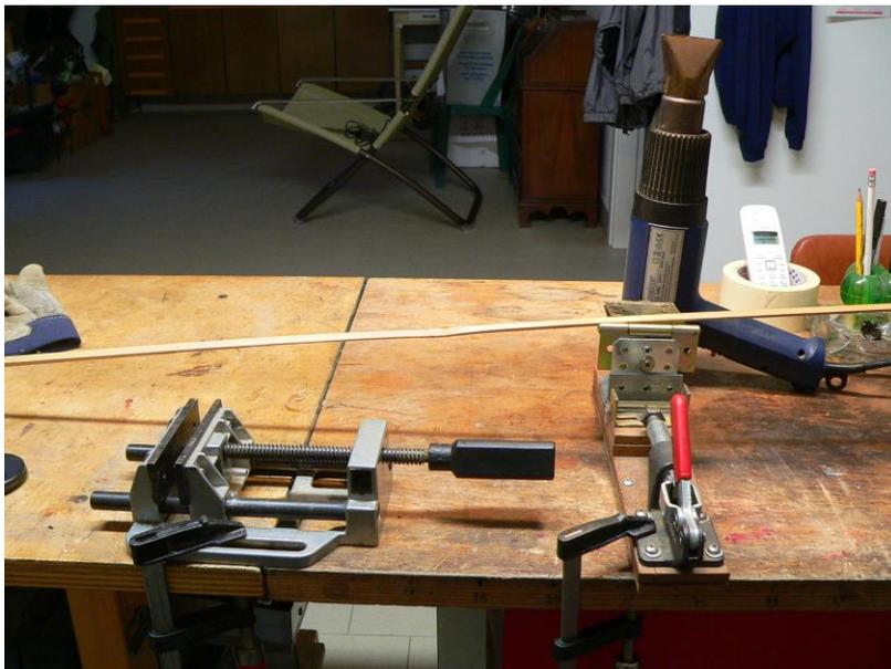
Foto 14 – morsa con ganasce lisce, pistola termica ed attrezzo con leva che spinge orizzontalmente un perno
