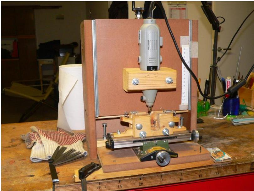
Foto 42 – fresatrice autocostruita, a 3 assi, per hollowing
