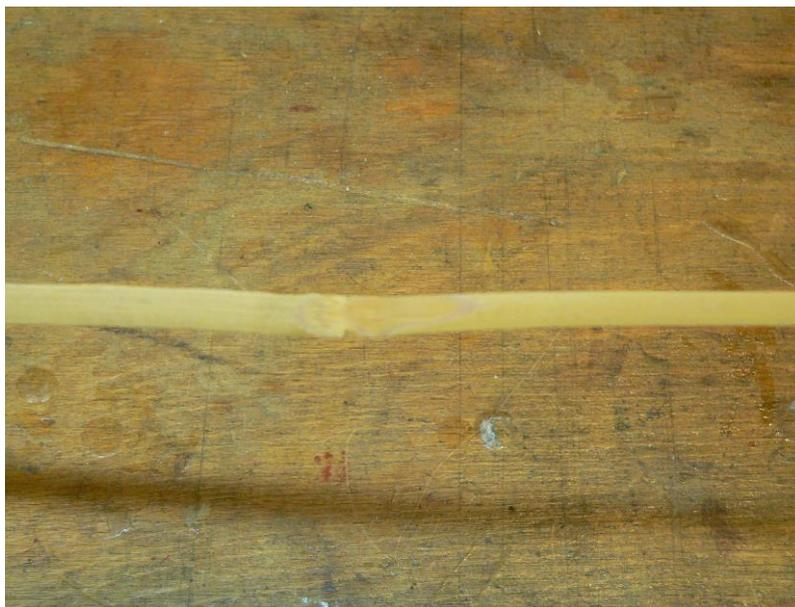
Foto 13 – nodo dopo splittaggio e levigatura (notare che le fibre sotto l' enamel seguono l'andamento del nodo flessso)
