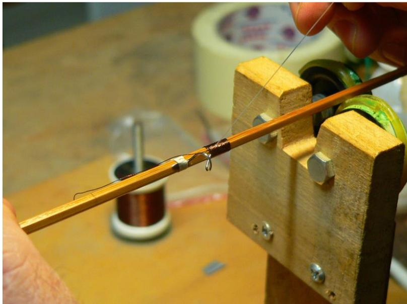
Foto 72 – si tira l'asola con inserito il capo finale del filo di montaggio per bloccarlo sotto le spire terminali (prima di estrarre completamente l'asola tagliare il filo in modo che poi non sporga dalle spire evitando quindi di usare lamette e/o fiamme per bruciare il residuo dal taglio)
