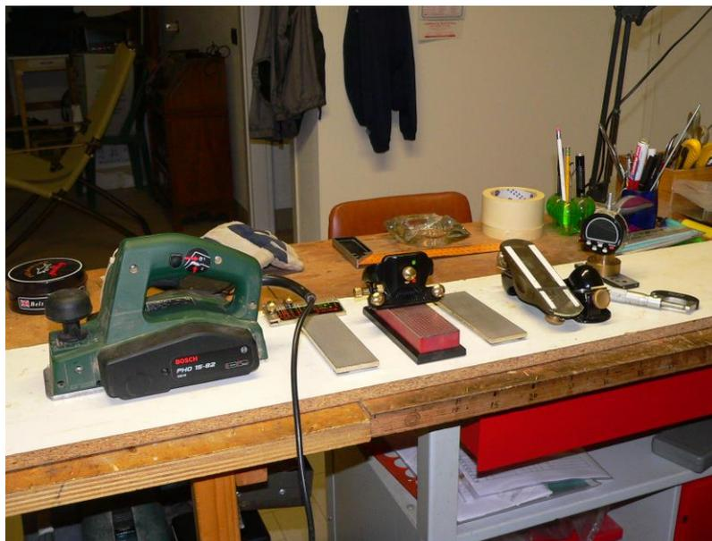
Foto 36 – attrezzatura per piallare a taper su PF
