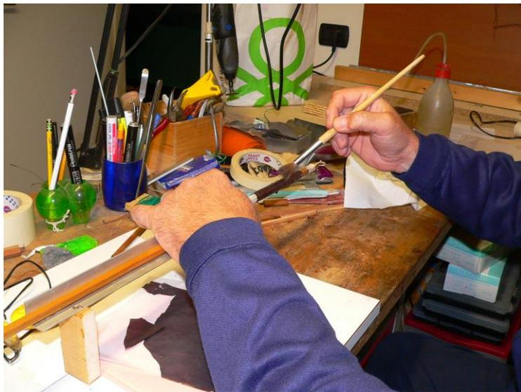
Foto 63 – si sparge la colla sulla grafite/ferrula e si attende che quasi asciughi, ma che sia ancora un po' appiccicosa
