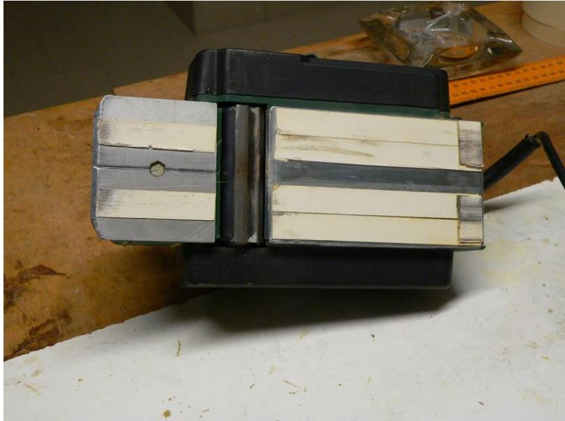
Foto 37 – soletta del pialletto elettrico con strisce incollate
