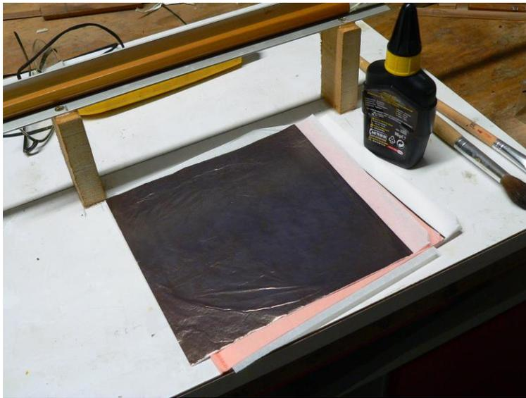
Foto 62 – materiali usati per rivestimento della ferrula (lamina in bronzo, colla, pennelli)
