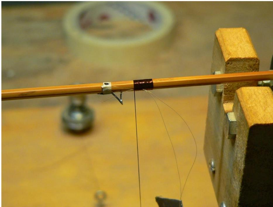
Foto 71 – avvolgimento del filo con asola per il suo bloccaggio inserita sotto una buona parte di spire finali
