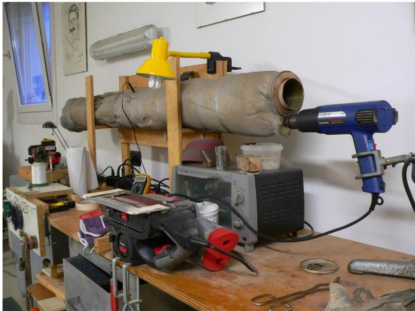
Foto 30 – forno con pistola riscaldante e termometro con sonda inserita a metà del tubo interno
